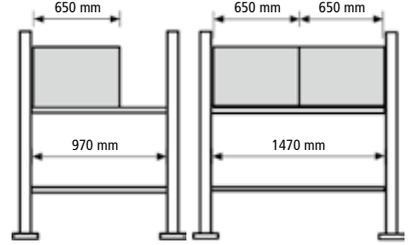
Nutzen Sie Ihre Lagerfläche optimal aus – Wir fertigen individuell Ihr Fachboden-Maß – von 570 mm bis 1470 mm lichte Fachbodenbreite im Raster von 50 mm.
