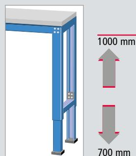
**Stufenlose Teleskop-Klemmschrauben-HöhenEinstellung** – HöhenEinstellbar von 700–1000 mm plus Tischplattenstärke
