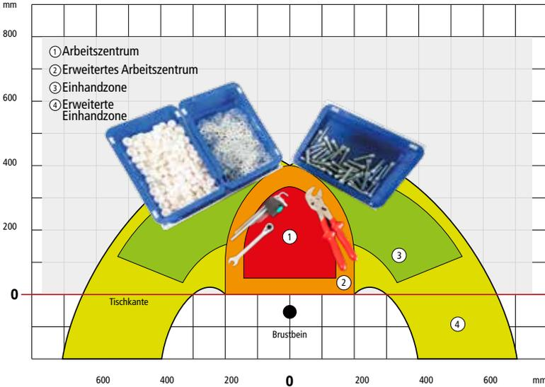
Empfohlene „Cockpit“-Positionierung nach BGI 650, bei Ellenbogenhöhe 5. Perzentil. Maximal Greifraumhöhe nicht über Herzhöhe.
